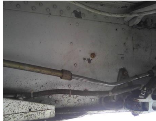
extended/bent gear conduits
